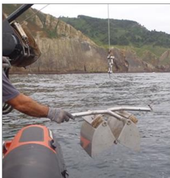
Fotografía 7.1. Dragas empleadas para el muestreo de sedimentos y bentos. En la imagen superior se observa la draga oceanográfica tipo “Day” y en la inferior, la draga oceanográfica tipo “Van Veen”.
