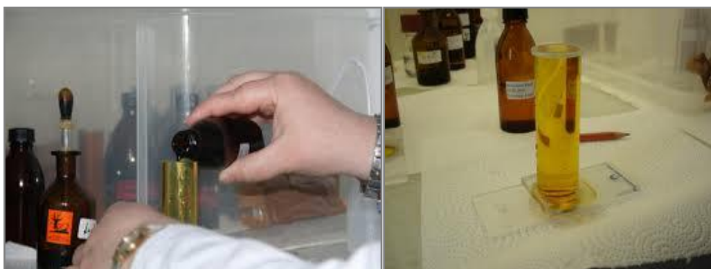
Figura 6.2 Utilización de cámaras de sedimentación para la preparación de las muestras de fitoplancton según el método de Utermöhl.
